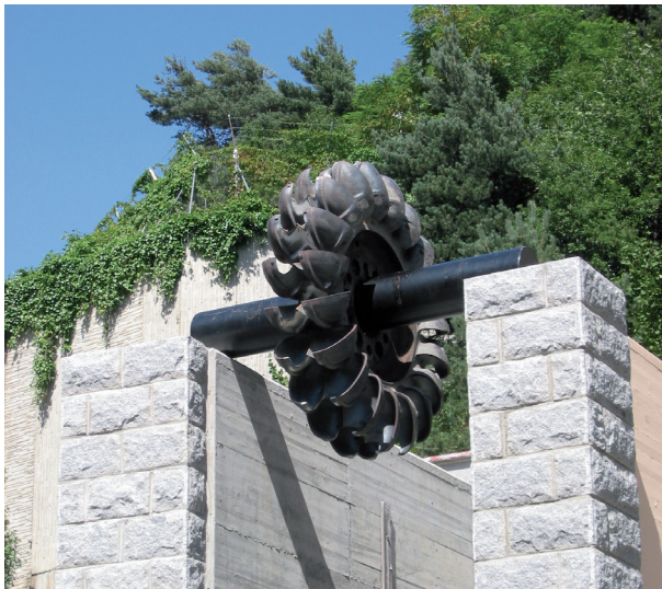
Roda de la turbina situada al peu de la canonada. © FEDA
